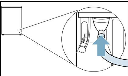
6. Другой конец сливного шланга, в зависимости от варианта подключения, закрепите при помощи соответствующей принадлежности.
