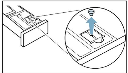
2. Поверните резервуар для конденсата на 180° на нижнюю сторону и удалите вставленную пробку.
